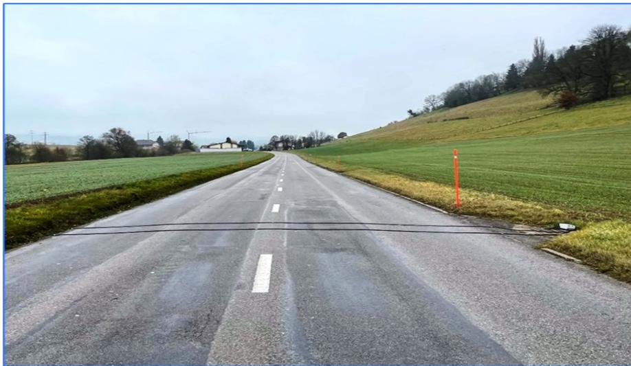
Le système de comptage bitube installé à la route de la Glâne
